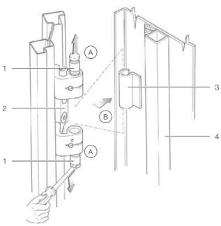
Fig. 18: Removing a door hinge
