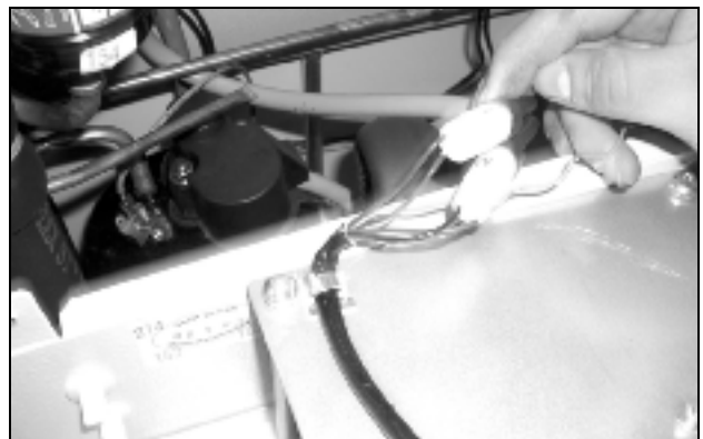
Kuva 73: Irrota tuulettimen pistokeliittimet (2)
