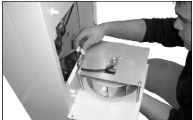
Kuva 72: Irrota tuulettimen pistokeliittimet (1)
