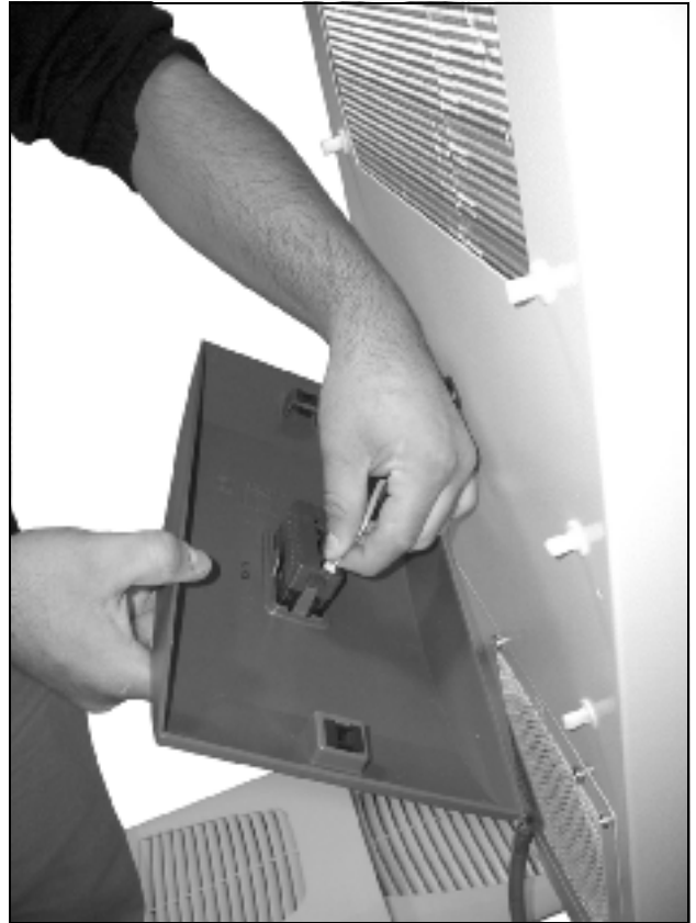
Kuva 45: Irrota näytön pistoke (1)
