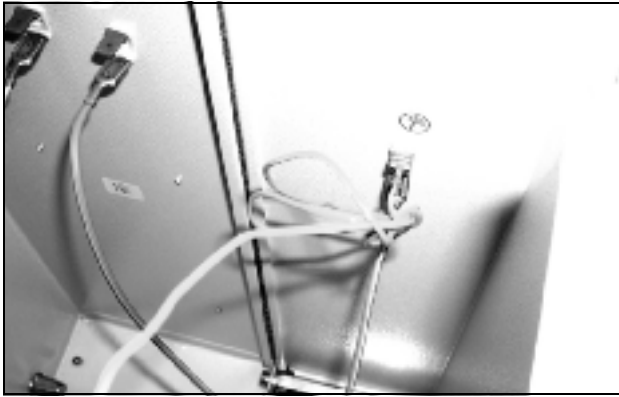
Kuva 75: Irrota tuulettimen maadoituskaapeli (1)
