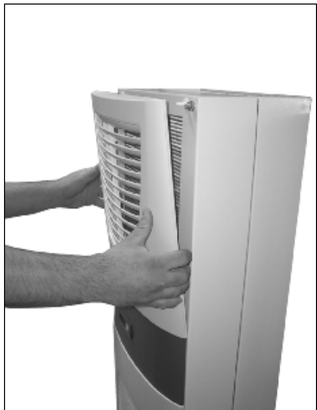
Kuva 42: Irrota ylempi lamellisäleikkö
