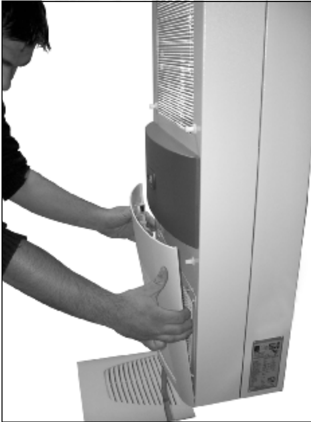
Kuva 43: Irrota alempi lamellisäleikkö
