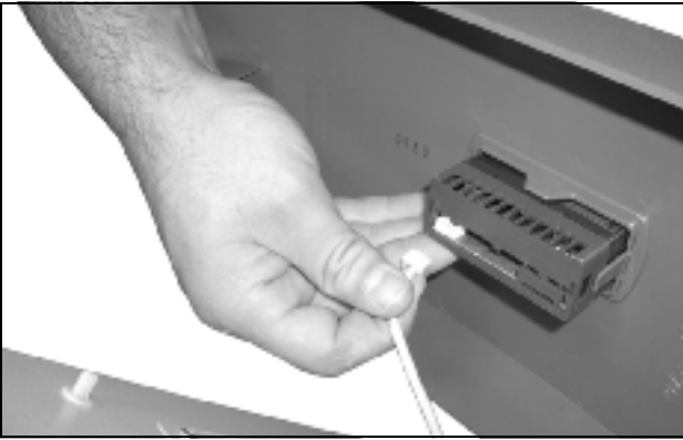
Kuva 67: Irrota näytön kaapeli
