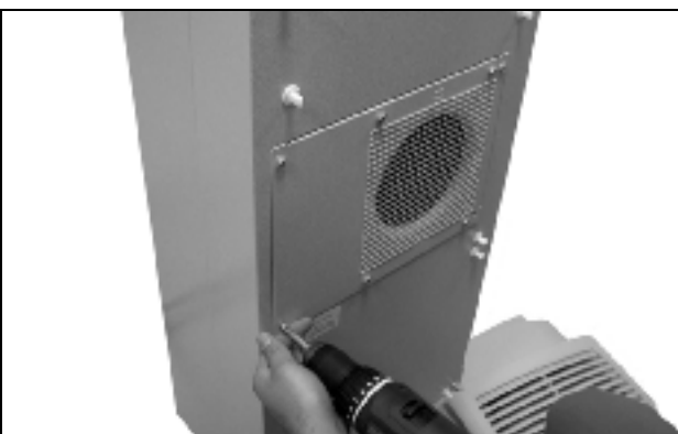
Kuva 70: Irrota ulkokierron tuulettimen neljä ruuvia
