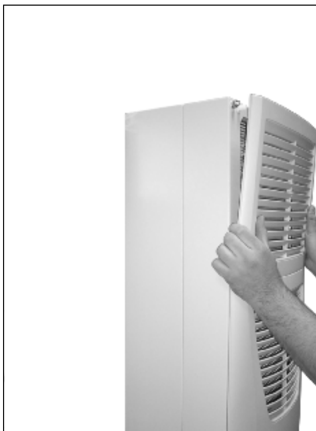
Kuva 62: Irrota ylempi lamellisäleikkö (2)
