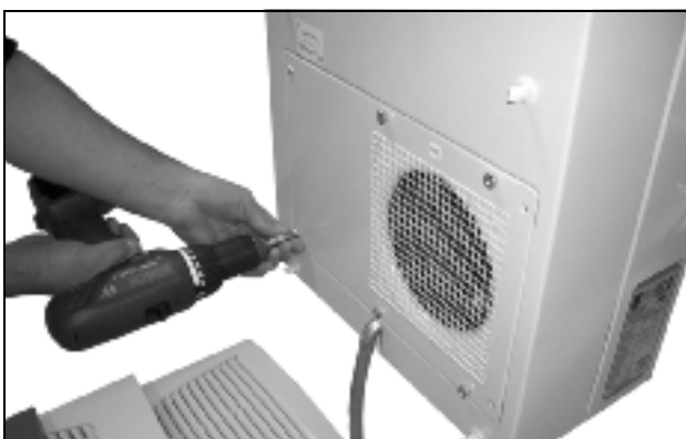
Kuva 48: Irrota ulkokierron tuuletin (avaa neljä ruuvia)
