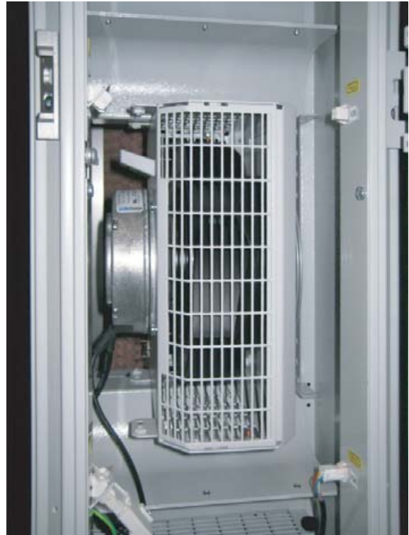
Fig. 20: Rotated fan module in fan tray
