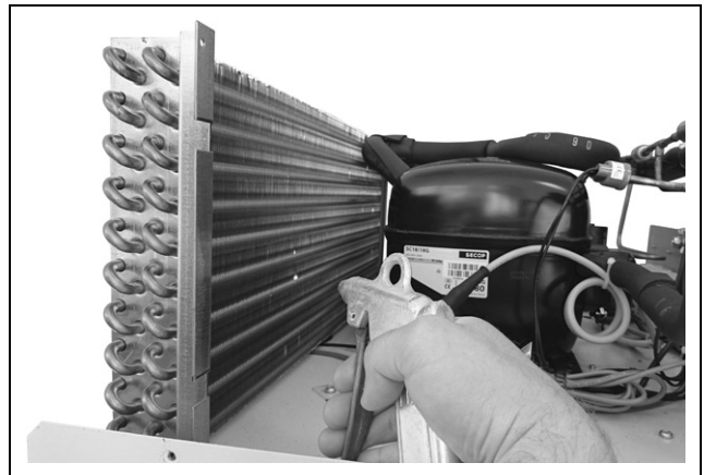
Abb. 30: Wärmetauschregister und Kompressorraum mit Druckluft ausblasen
