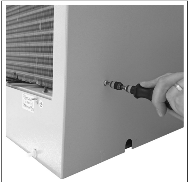
Abb. 26: Befestigungsschrauben der Haube entfernen (vier Schrauben lösen)
