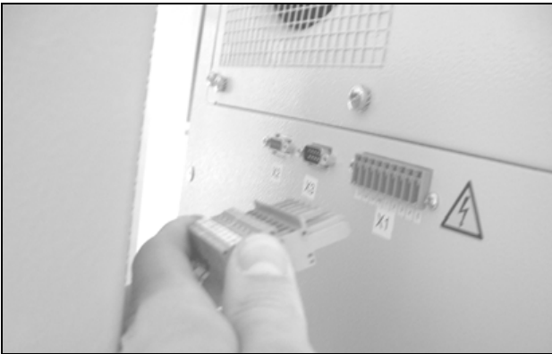
Fig. 53: Desconectar a alimentação de tensão
