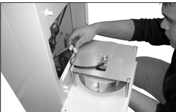
Fig. 65: Desencaixar os conectores do ventilador (1)
