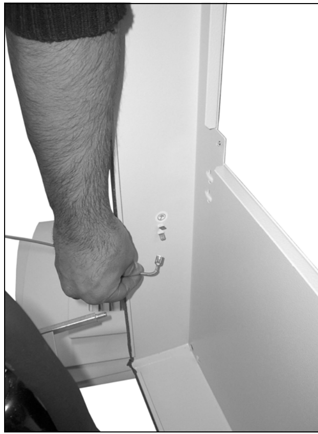
Fig. 73: Desencaixar o cabo de aterramento (2)
