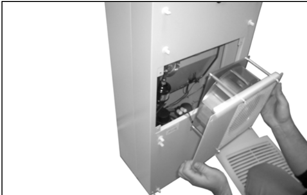
Afb. 64: Ventilator extern circuit uitbouwen
