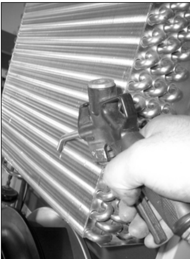
Obr. 51: Vyfoukání žeber výměníku tepla a prostoru kompresoru stlačeným vzduchem (1)
