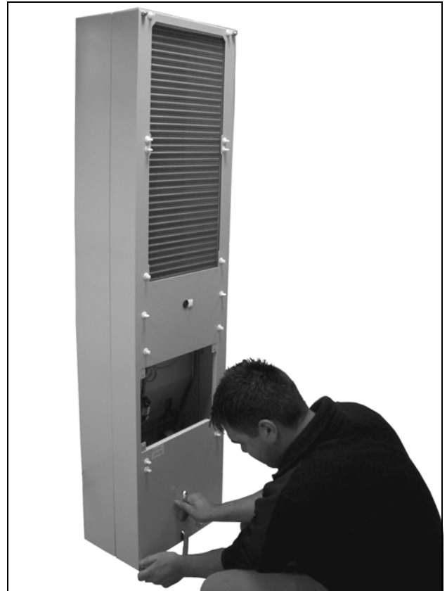
Obr. 70: Uvolnění čtyř matic krytu
