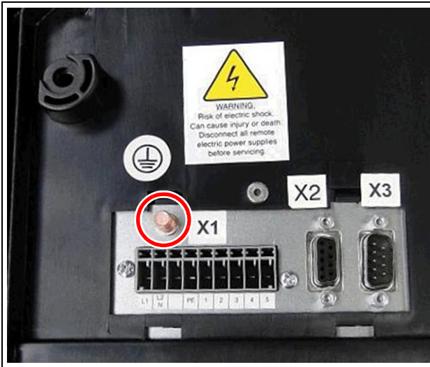
Obr. 11: Připojovací bod, vyrovnání potenciálů
