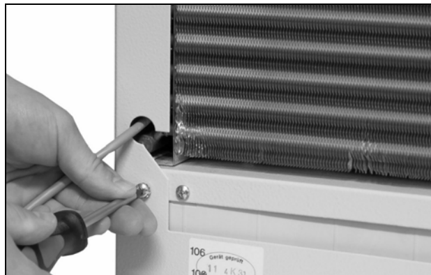
Obr. 26: Odstranění upevňovacích šroubů krytu (uvolnění čtyř šroubů)
