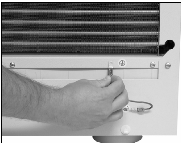
Obr. 25: Odpojení uzemňovacího kabelu
