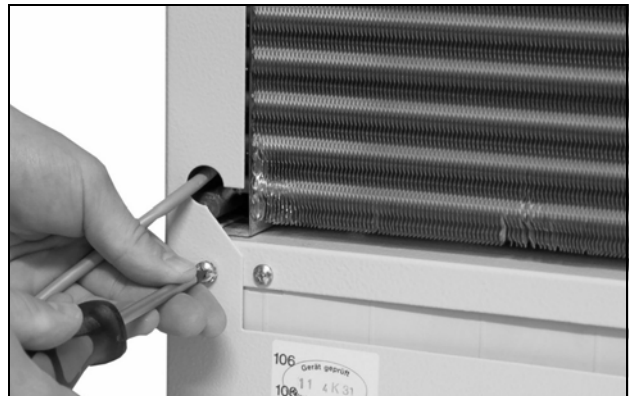
Bild 26: Ta bort huvens fastsättningskruvar (lossa de fyra skruvarna)
