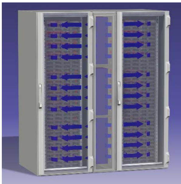
Obr. 8: LCP Rack na dvou serverových skříních
