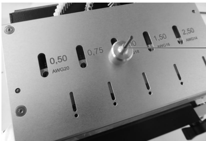
Fig. 8: Perno di fissaggio superiore
