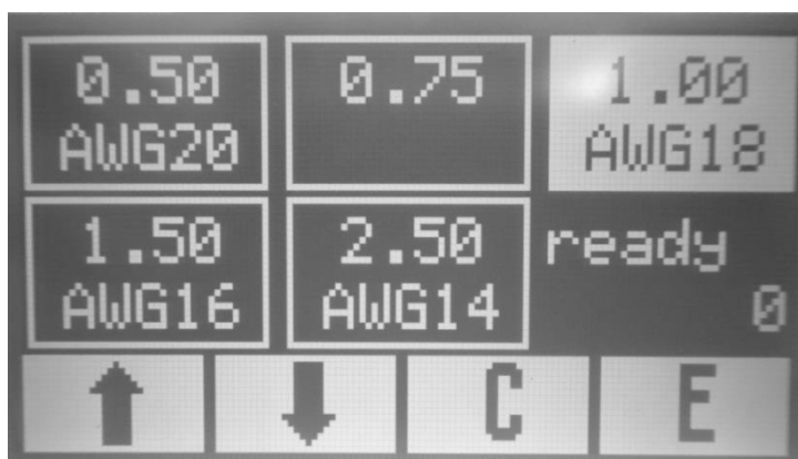
Fig. 15: Display a sfioramento, videata menu di selezione
