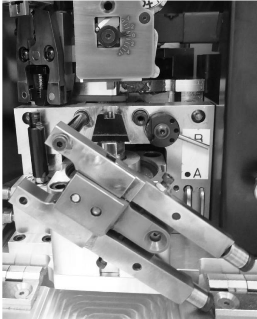
Fig. 20: Unità di fissaggio dei trefoli smontata
