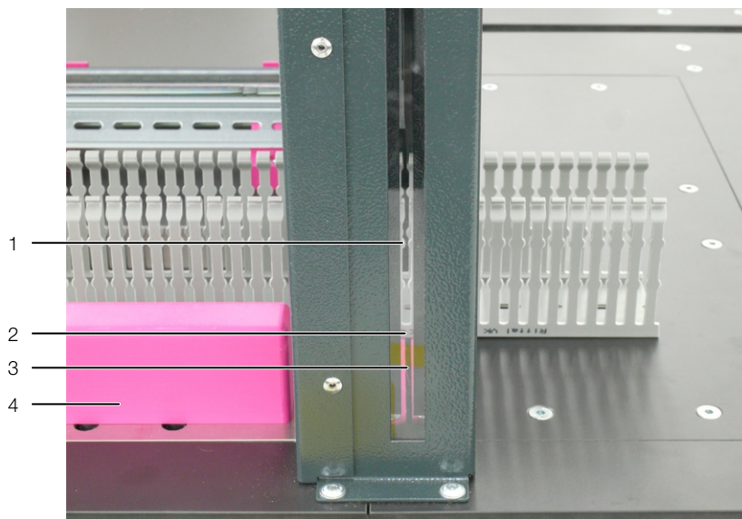
Fig. 13: Justering af en kabelkanal
