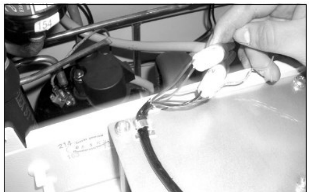
图71: 断开风扇接头 (2)
