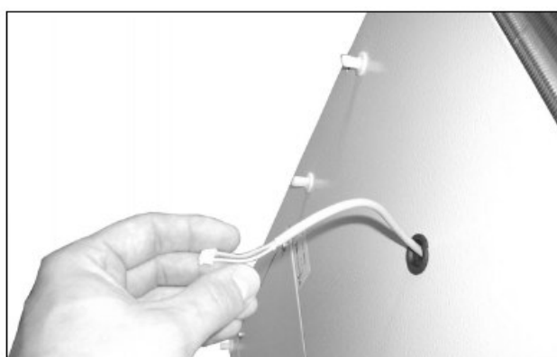
图50: 推回显示器电缆
