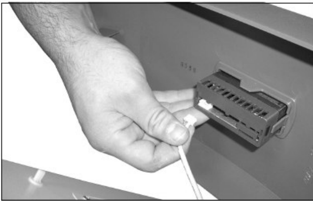
图65: 断开显示器电缆
