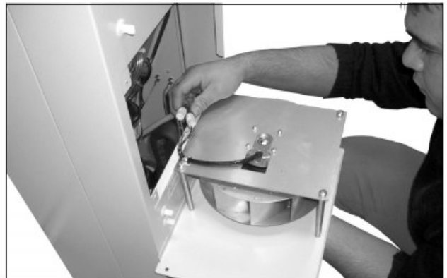
图70: 断开风扇接头 (1)
