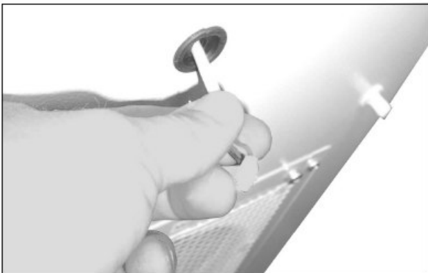
图66: 推回显示器电缆并将其推过电缆护孔 (1)
