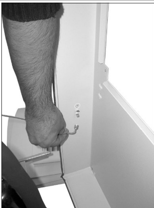
图78: 断开接地电缆 (2)
