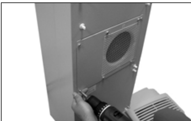
Abb. 68: Vier Schrauben des Außenkreislauflüfters lösen
