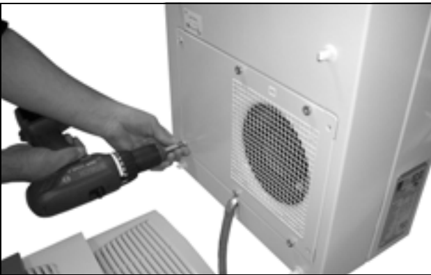
Abb. 46: Außenkreislaufflüter ausbauen (vier Schrauben lösen)
