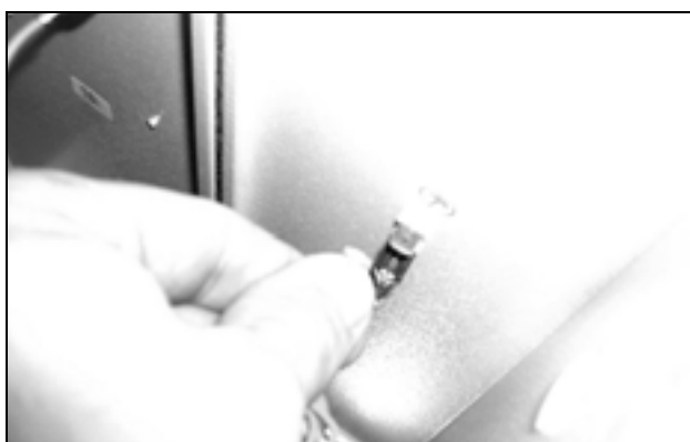
Abb. 74: Erdungskabel des Lüfters abziehen (2)
