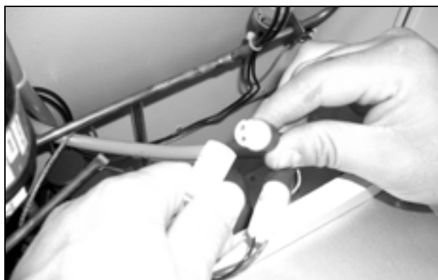
Abb. 72: Steckverbindungen des Lüfters abziehen (3)
