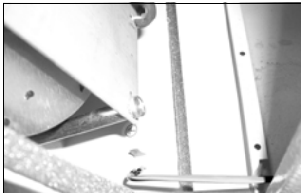
Abb. 54: Erdungskabel zwischen Haube und Chassis lösen (1)
