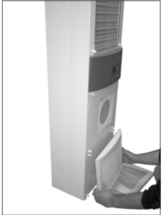
Abb. 63: Unteres Lamellengitter entfernen (2)
