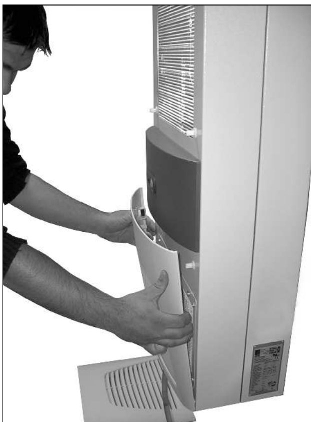
Afb. 40: Onderste ventilatierooster verwijderen
