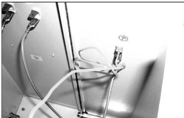
Afb. 72: Aardingskabel van de ventilator losnemen (1)
