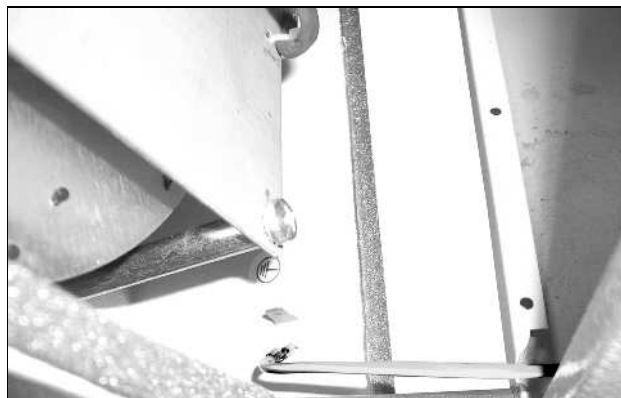
Afb. 53: Aardingskabel tussen afdekkap en chassis losnemen (1)
