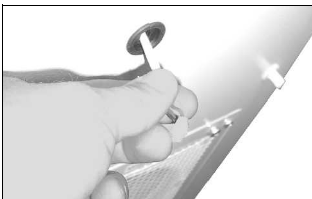
Afb. 65: Displaykabel terugschuiven en door de kabeldoorvoer duwen (1)
