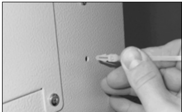
Abb. 18: Einclipskabelbinder zur Zugentlastung an der vorderen Gehäusehälfte des Klimamoduls anbringen
