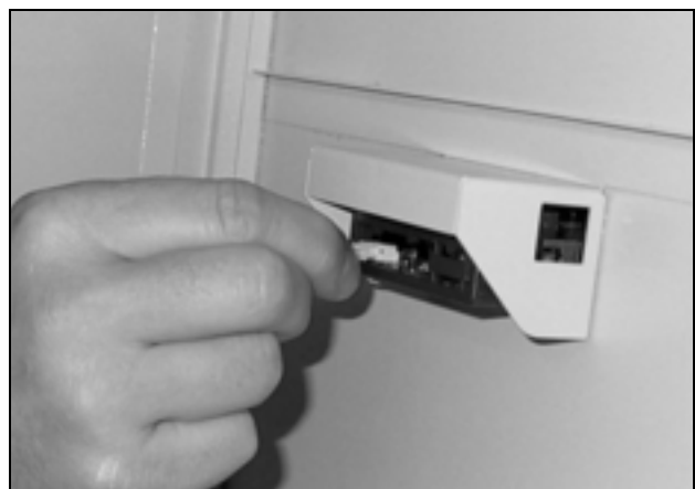
Abb. 29: Stecker vom Display abziehen
