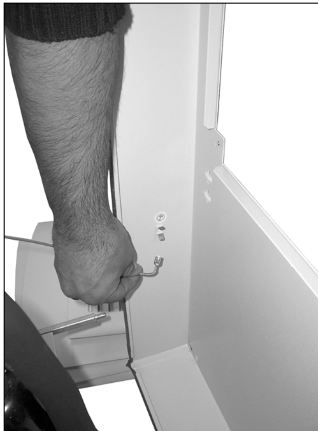
Imagen 73: Desconectar el cable de puesta a tierra (2)
