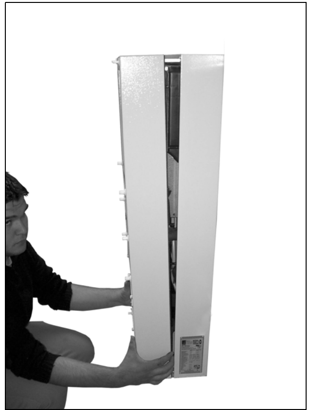
Imagen 48: Retirar la cubierta (2)
