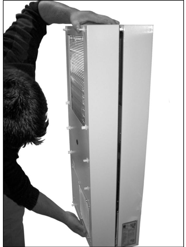
Imagen 47: Retirar la cubierta (1)
