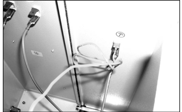
Imagen 68: Desconectar el cable de puesta a tierra del ventilador (1)
