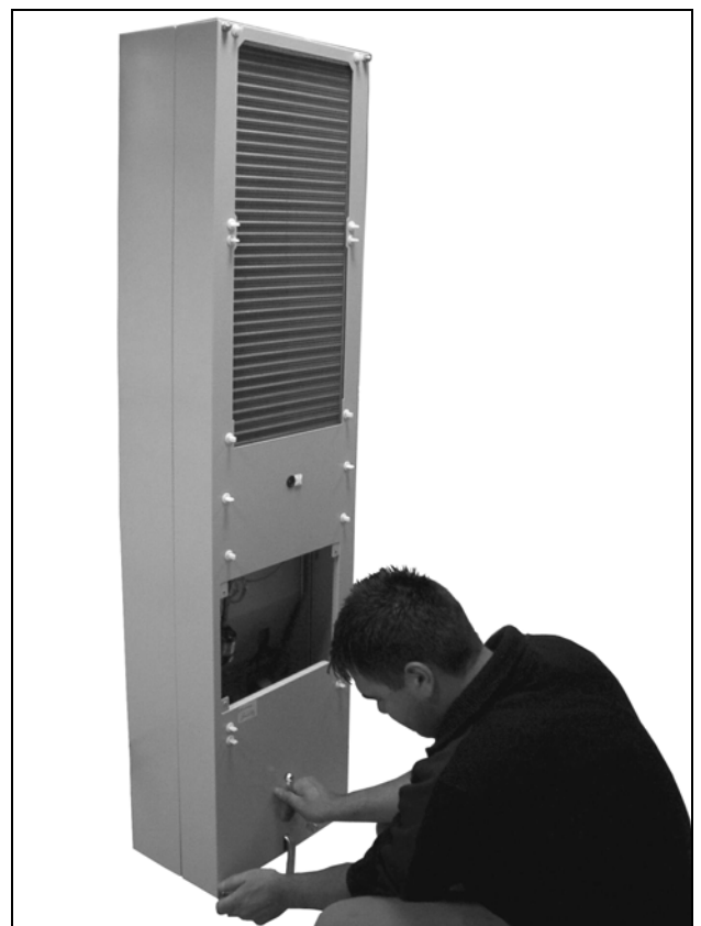
Imagen 70: Desenroscar las cuatro tuercas de la cubierta
