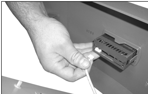
Imagen 60: Desconectar el cable del display
