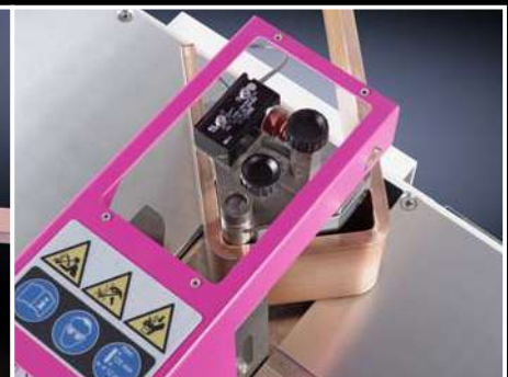
Cintrage d'une barre de courant
