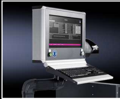
Commande de la machine avec clavier et impression d'étiquettes pour l'affectation par projet des coupes lors de l'utilisation de l'optimisation des chutes
