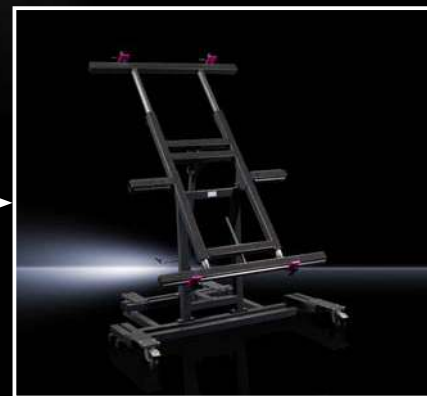
Établis de montage Rittal Manutention flexible et aisée en atelier. Établis de montage réglables au niveau de leur hauteur et de leur inclinaison pour pouvoir équiper et câbler en toute ergonomie les plaques de montage d'armoires électriques ou les armoires électriques dans leur globalité, voir page 606
