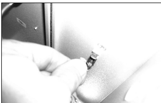
Рис. 74: Отсоединение кабеля заземления вентилятора (2)
