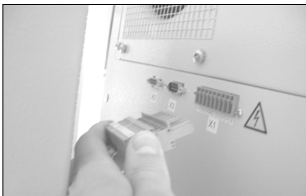
Рис. 58: Отсоединение сетевого штекера
