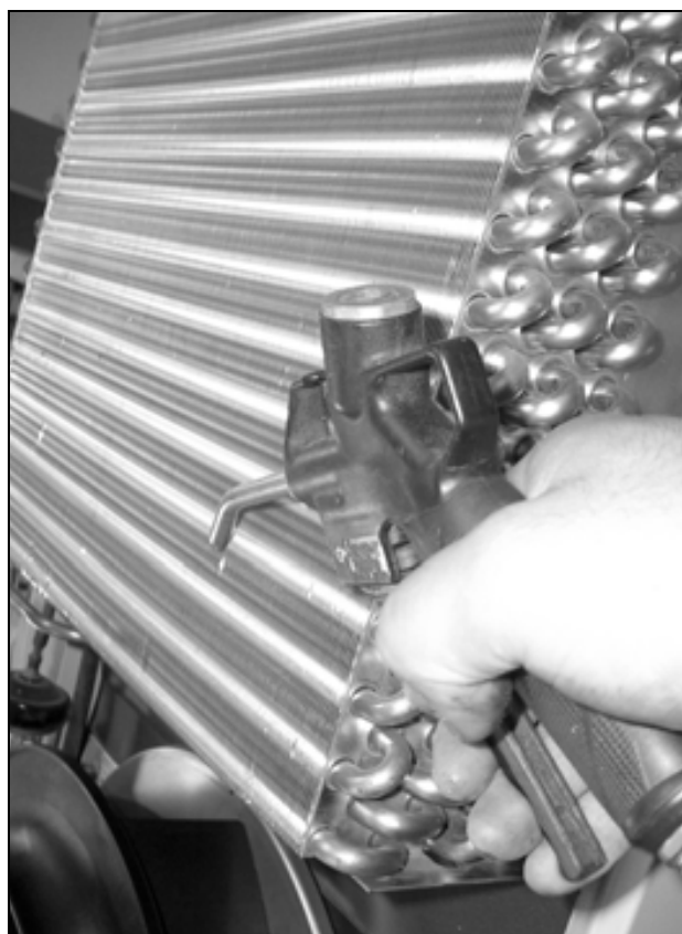
Рис. 56: Продувка теплообменного элемента и компрессорного отделения сжатым воздухом (1)
