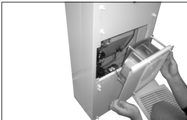
Рис. 69: Демонтаж вентилятора внешнего контура
