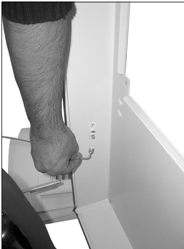
Рис. 78: Отсоединение кабеля заземления (2)
