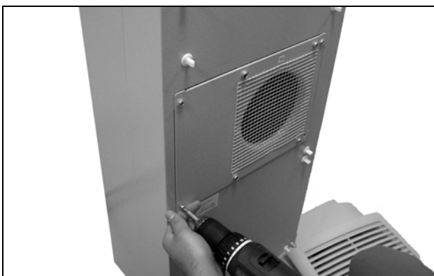
Рис. 68: Отвинчивание четырех винтов вентилятора внешнего контура
