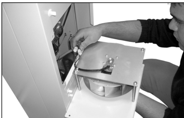
Рис. 70: Отсоединение штекеров вентилятора (1)
