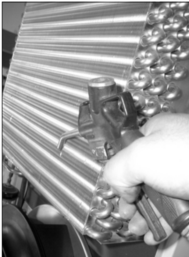
Рис. 80: Продувка теплообменного элемента и компрессорного отделения сжатым воздухом (2)
