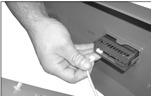
Рис. 65: Отсоединение кабеля дисплея
