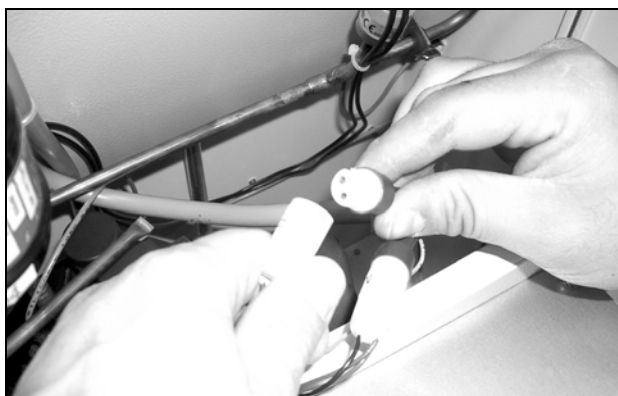
Рис. 72: Отсоединение штекеров вентилятора (3)
