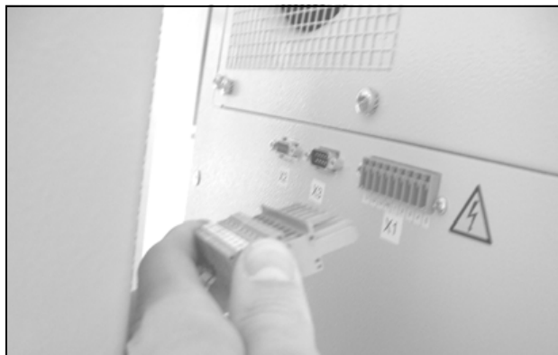
Рис. 39: Отсоединение сетевого штекера
