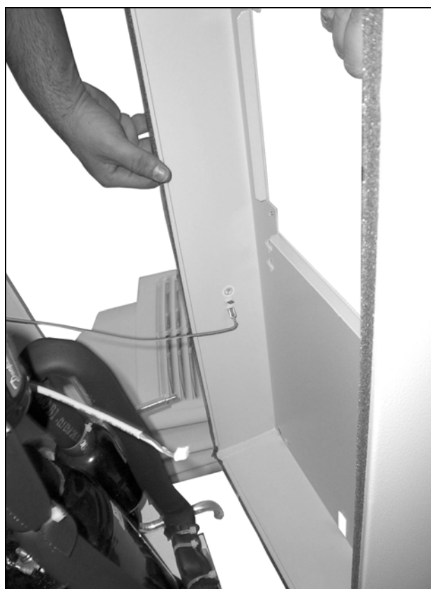
Рис. 77: Отсоединение кабеля заземления (1)
