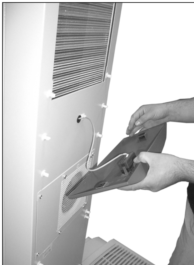
Рис. 64: Снятие средней панели
