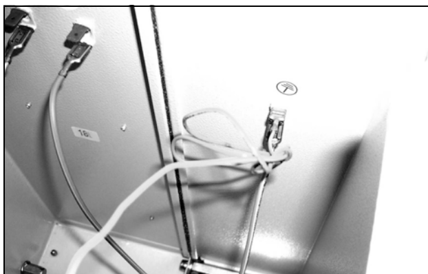
Рис. 73: Отсоединение кабеля заземления вентилятора (1)
