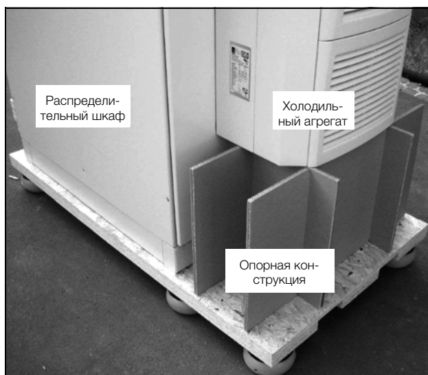
Рис. 1: Транспортировка шкафа с агрегатом
