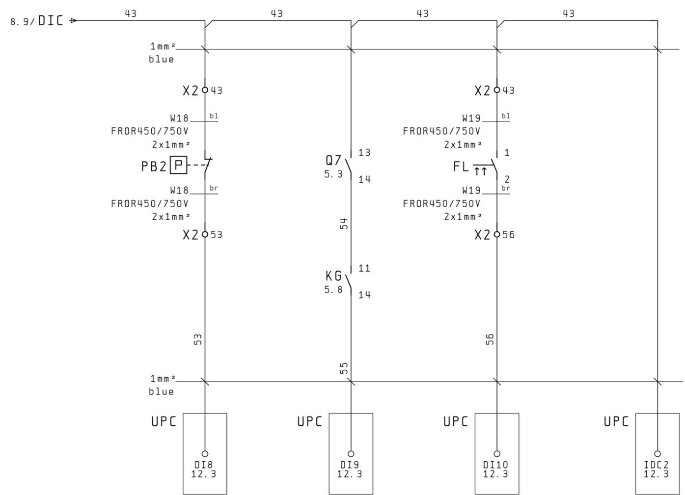
LOW PRESSURE SWITCH 2      PUMP OVERLOAD/ PHASE ROTATION      FLOW SWITCH      COMMON DIC2
