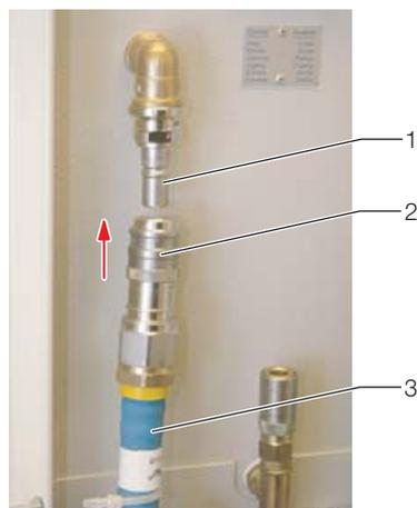
Рис. 39: Быстросъемная муфта на подводе охлаждающей воды
