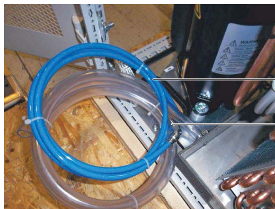
Рис. 50: Шланг с элементом подключения, наружная резьба 1/8"
