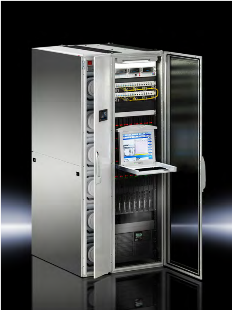
Najbardziej kompaktowa jednostka centrum danych: szafa IT z chłodzeniem, monitoringiem, UPS, serwerami i siecią
