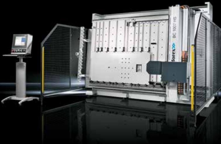
Für das vollautomatische, schnelle, exakte und verlässliche Bearbeiten – Bohren, Gewindeschneiden und Fräsen – von Montageplatten, Türen, Dachblechen, Seitenteilen, Bodenblechen oder kompletten nicht zerlegbaren Gehäusen. Es lassen sich alle im Steuerungsbau üblichen Materialien wie: Stahl, Edelstahl, Aluminium, Kupfer und auch Kunststoff sehr rationell, selbst bei Losgröße 1, bearbeiten. Des Weiteren profitiert der Anwender von der deutlich höheren Präzision und Wiederholgenauigkeit.
