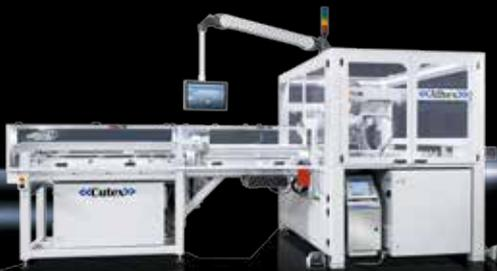
Mit dem System lässt sich die Bestückung mit verschiedenen Klemmen aller namhafter Hersteller automatisieren, beschleunigen und zuverlässiger gestalten. Die großzügigen Magazinkapazitäten der bis zu 40 Klemmagazine minimieren Stillstands- und Wartezeiten und erhöhen die Flexibilität. In Verbindung mit dem Cutex, der auch einzeln bestellbar ist, werden die Tragschienen vor der Bestückung automatisch aus dem Magazin zugeführt, auf Länge geschnitten und beschriftet.
