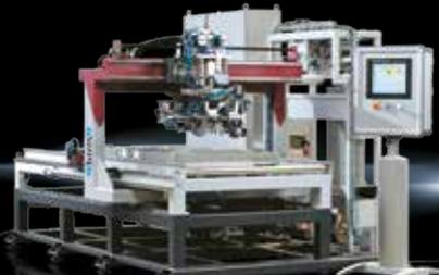
Das Verdrahtungszentrum beschleunigt den Verdrahtungsprozess um mehr als ein Vierfaches, bei gleichzeitiger Minimierung der Arbeitsstunden. Der um 270 Grad drehbare, patentierte Bearbeitungskopf konfektioniert die Drahtenden, verlegt die Drähte in die Kabelkanäle und schließt sie an den Komponenten an. Der Drahtwechsel erfolgt automatisch. Optional können Drähte auch bedruckt werden.
