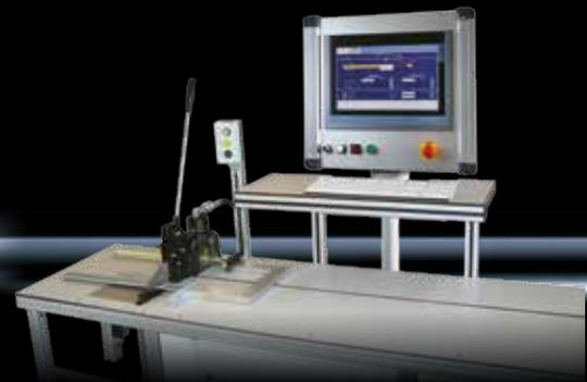
Mit dem Secarex Zuschnittszentrum lassen sich Verdrahtungskanäle, Kabelkanaldeckel und Tragschienen schnell und zuverlässig zuschneiden. Neben deutlicher Zeitersparnis profitieren Anwender von sehr geringen Verschnittkosten durch Verschnittoptimierung.
