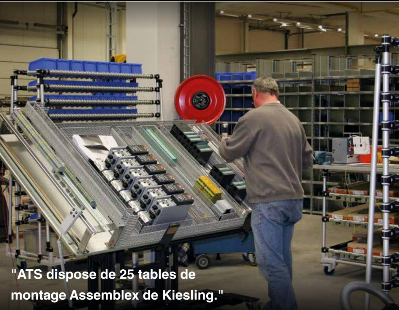
"ATS dispose de 25 tables de montage Assemblex de Kiesling."
