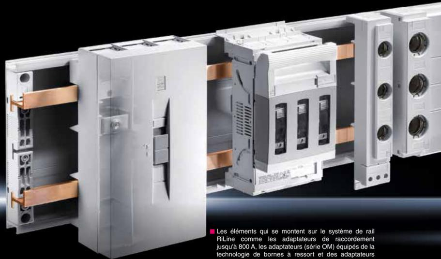
Les éléments qui se montent sur le système de rail RiLine comme les adaptateurs de raccordement jusqu'à 800 A, les adaptateurs (série OM) équipés de la technologie de bornes à ressort et des adaptateurs pour les disjoncteurs de puissance (série CB) jusqu'à 250 A conviennent pour les applications DC.
