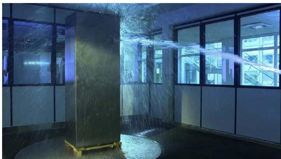
Abbildung 3: IP-Schutzartprüfung
