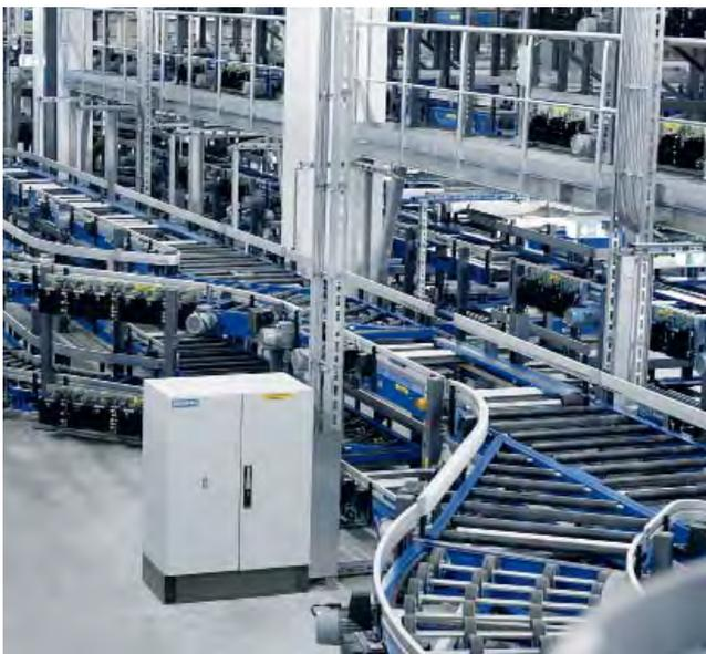
Siemens 제어 기술의 수하물 처리 시스템의 중심에는 신뢰할 수 있는 보호력이 제공되는 리탈의 분산형 CM 콤팩트 시스템 인클로저가 있습니다.
