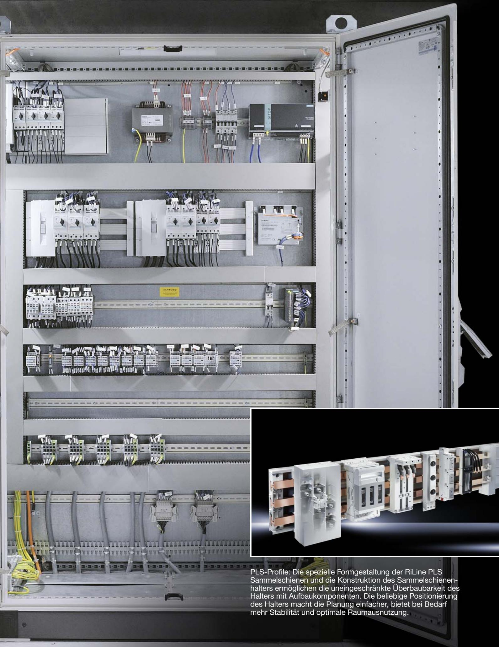
PLS-Profile: Die spezielle Formgestaltung der RiLine PLS Sammelschienen und die Konstruktion des Sammelschienenhalters ermöglichen die uneingeschränkte Überbaubarkeit des Halters mit Aufbaukomponenten. Die beliebige Positionierung des Halters macht die Planung einfacher, bietet bei Bedarf mehr Stabilität und optimale Raumnutzung.
