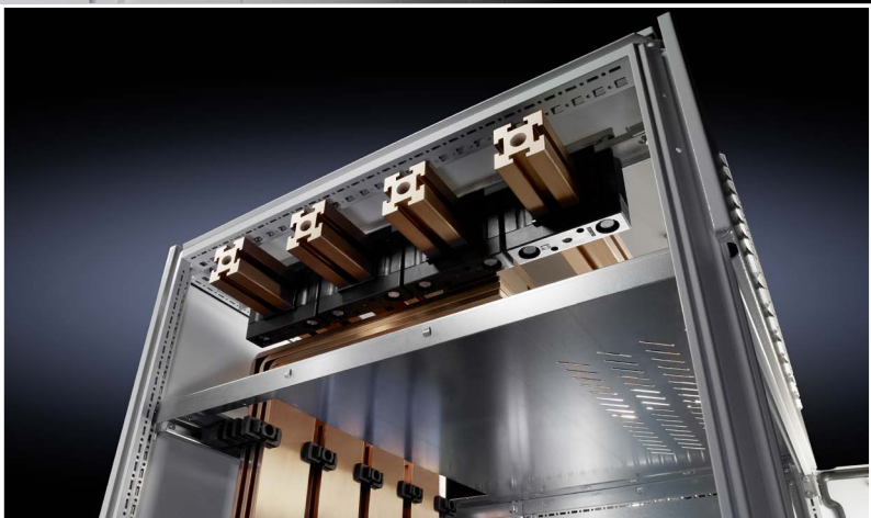
Maxi-PLS – удобно монтируемая система Ri4Power: компактная конструкция для центрального электрораспределения до 4000 А – простое и бесступенчатое крепление на 4 уровнях – контактирование кабелей и устройств без сверления благодаря системе закладных гаек
