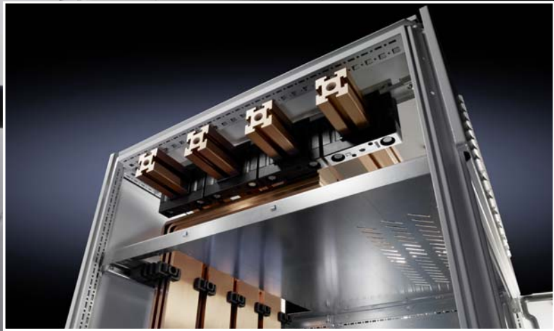
Maxi-PLS – le système Ri4Power facile à monter : une conception particulièrement compacte pour la distribution centralisée de courant jusqu'à 4000 A – fixation et mise en contact aisées, sans perçage et en continu des câbles grâce à des rainures intégrées sur les 4 faces de la barre
