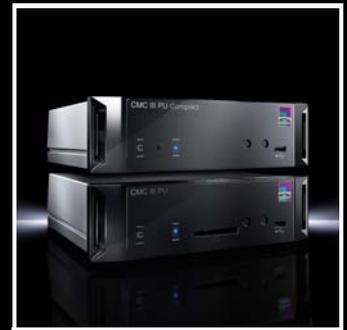
Computer Multi Control III (CMC III) контролирует температуру, влажность воздуха, наличие дыма, расход энергии и доступ. Система CAN-Bus (Controller Area Network) обеспечивает минимум затрат при прокладке кабеля и установке.
