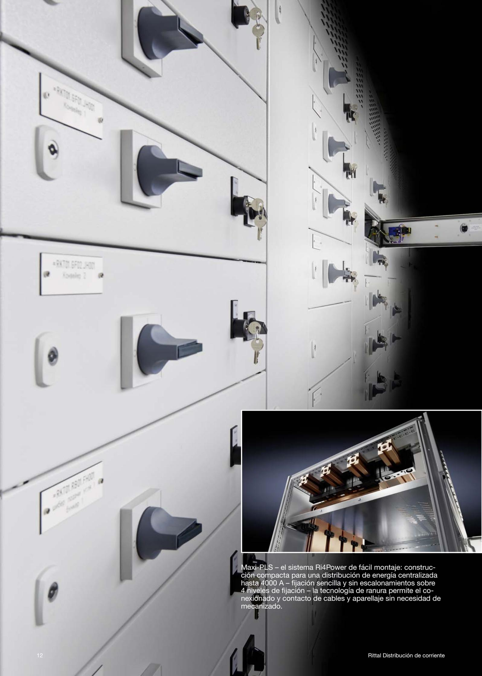
Maxi-PLS – el sistema Ri4Power de fácil montaje: construcción compacta para una distribución de energía centralizada hasta 4000 A – fijación sencilla y sin escalonamientos sobre 4 niveles de fijación – la tecnología de ranura permite el conexionado y contacto de cables y aparellaje sin necesidad de mecanizado.
