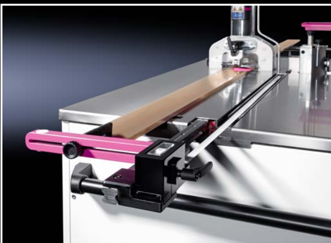
■ Wsuwany system pomiarowy do 1200 mm do skracania, gięcia i wykrawania (składany)
