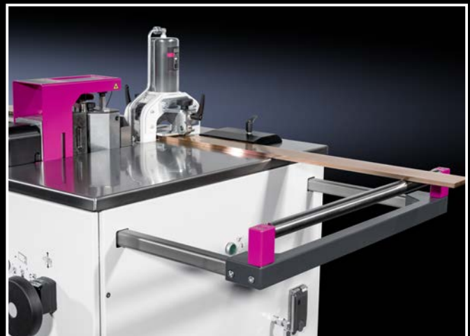
■ Wyciągane z boku przedłużenie podparcia do długich szyn miedzianych
