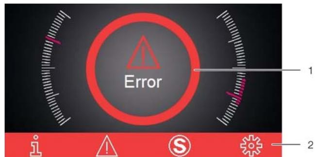
Рис. 24: Экран при возникновении неисправности
