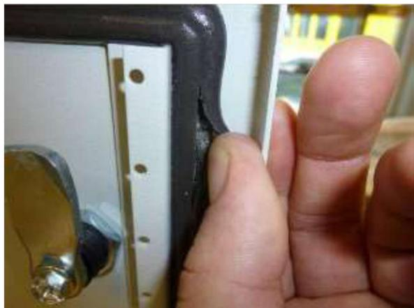
Photo 4 : conséquence possible d'un test IK
