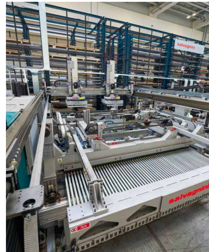
Das Hochregallager bietet 800 Regalplätze, aus denen die Bleche automatisch entnommen und zur Laserschneidanlage transportiert werden.
