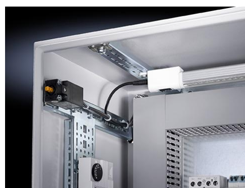
Rittal AE kompaktapparatskap med installasjonsskinne gir mange muligheter. Skinne er enkel å montere selv om montasjeflaten allerede er satt inn i skapet. En dørbryter kan f.eks. monteres på skinne.
