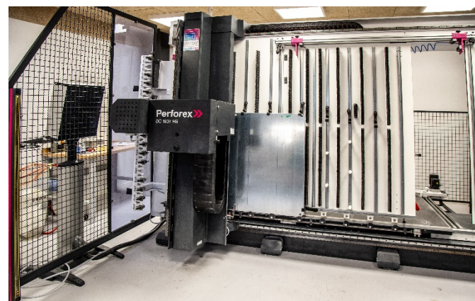
KL Automatik ApS har installeret et fuldautomatisk bearbejdningscenter Perforex BC 1007 HS fra RITTAL til boring og fræsning af huller samt skæring af gevind i bundplader og skabsvægge.
