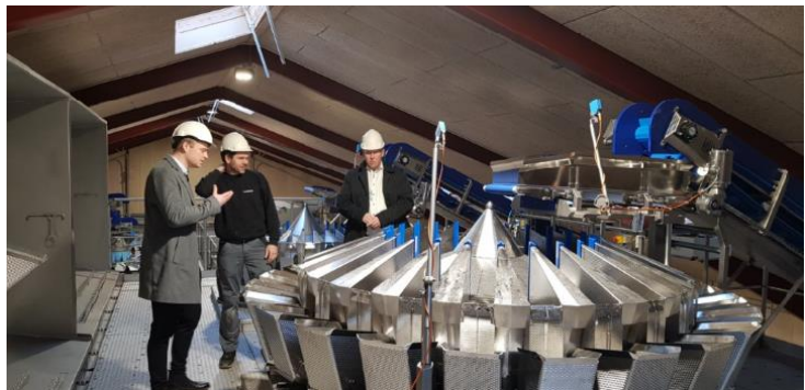
Billedetekst: Ansatte fra Rittal og Cabinplant inspicerer her den øverste del af kombinationsvægten, hvor kyllingeprodukterne ledes ind i vægten. Vægten er optimeret, så 'give away' nærmer sig nul.
