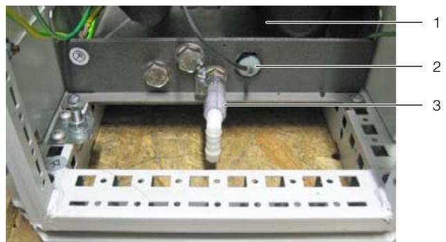
Fig. 46: Condensate discharge
