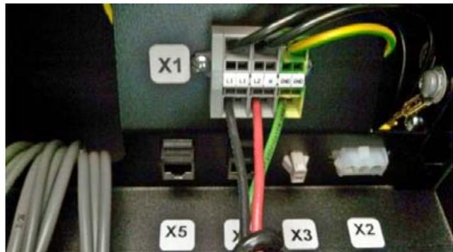
Fig. 42: Terminal connection X1
