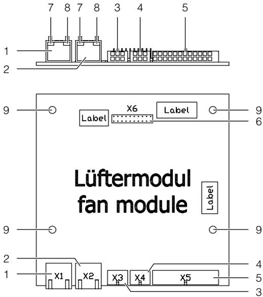
Fig. 91: Control unit fan module – rear/top view
