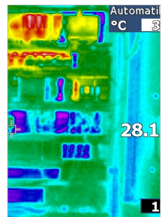
Mit einer Wärmebildkamera lassen sich Hotspots einfach aufspüren.
