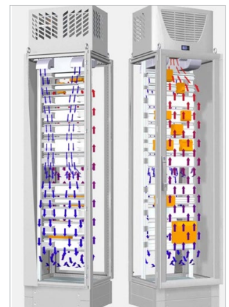
Mit gezielter Luftführung lassen sich bis zu 23 % Energie sparen.
