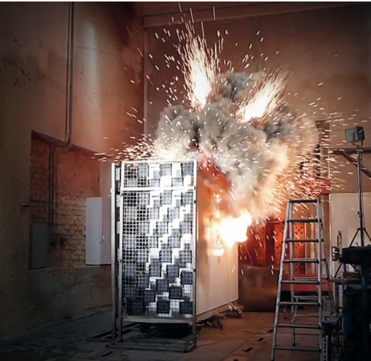
Rittal hat sein Ri4Power System geprüft und zertifiziert.
