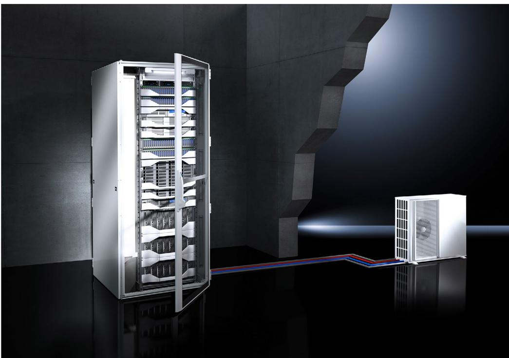
Die Lösung LCU DX von Rittal besteht aus einer Inneneinheit mit drehzahlgeregelten EC-Lüftern (bürstenloser Gleichstrommotor) zur Montage im IT-Rack sowie einem Inverter-geregelten Verdichter für den Außenbereich und ist in den Leistungsklassen bis 3 und bis 6,5 kW lieferbar.
