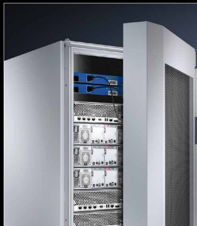
Das LCP Hybrid in der Rücktür des TS IT Racks, direkt hinter dem Equipment, gibt gekühlte Abluft in den Raum ab.
