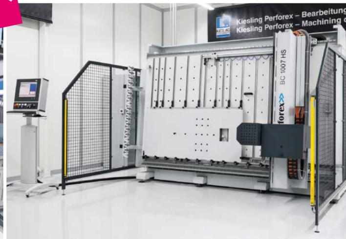
Um Gehäuseteile wie Schaltschranktüren, Seitenteile und Montageplatten zu bearbeiten, kommen unter anderem Perforex-Maschinen von Kiesling Maschinenteknik zum Einsatz.
