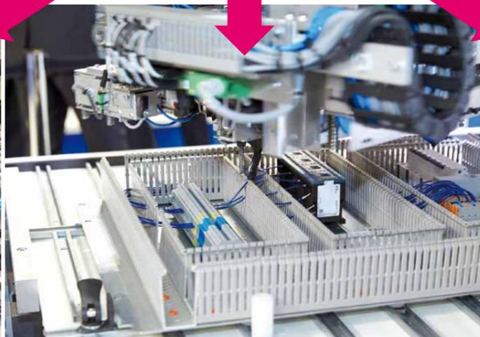
Zukunftsmusik: Bereits heute lassen sich Montageplatten mit dem Averex-Verdrahtungsroboter innerhalb kürzester Zeit verdrahten.
