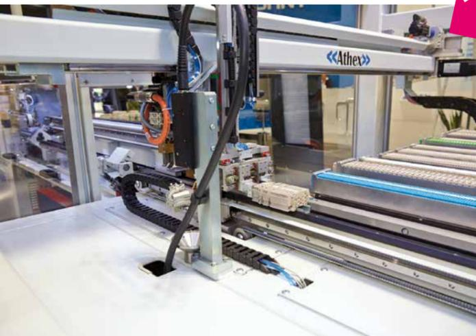
Der Bestückungsautomat Athex kann je nach Ausstattung bis zu 6.000 Klemmen aufnehmen und diese automatisiert auf Hutschienen montieren.
