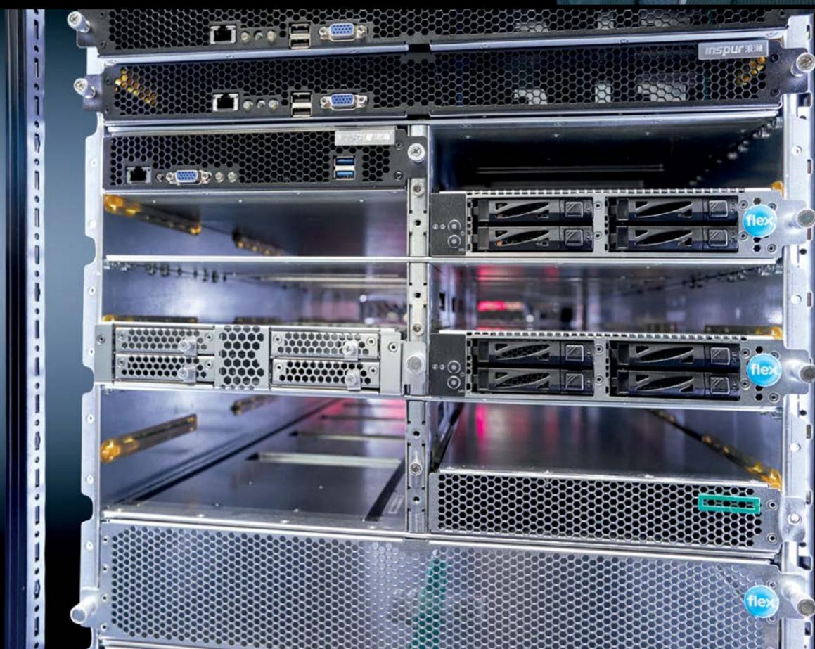
**Energieeffizient:** Mit dem Open19-Rack bietet Rittal eine Gleichstrom-Lösung auf der gängigen 19“-Rack Basis. Die Anschlüsse werden nicht auf eine zentrale Stromschiene an der Rückseite des Schrankes adaptiert, sondern über einen speziellen Kabelbaum auf der Rückseite mit den Power-Shelves verbunden.
