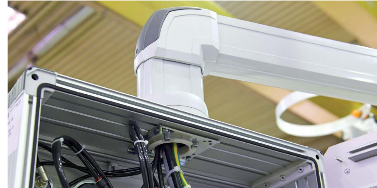
Im Tragarm finden sämtliche Leitungen inklusive der Pneumatik-Leitungen bequem Platz.
