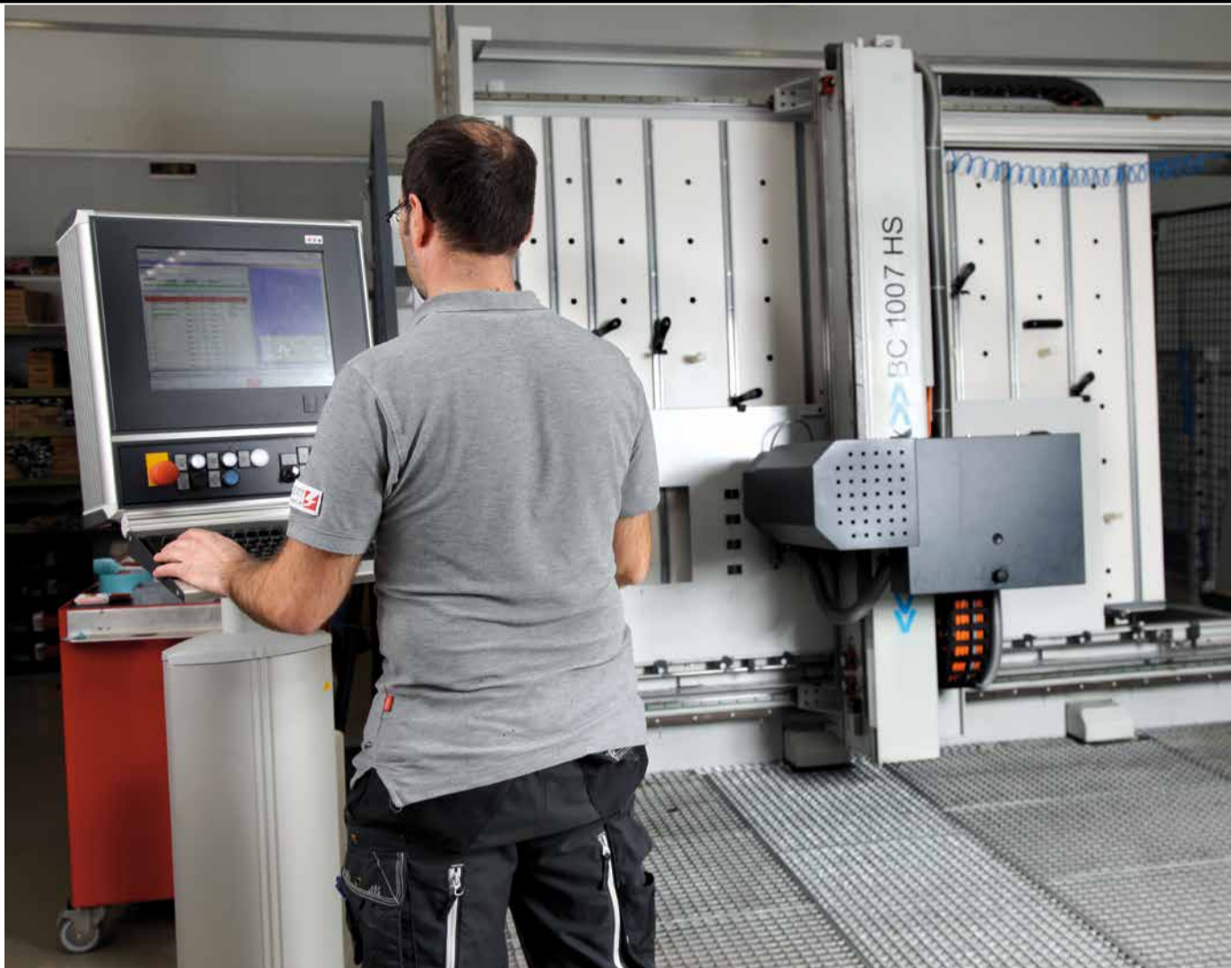
Der Datenaustausch erfolgt über die Schnittstelle zwischen der Eplan CAD-Software und dem Kiesling-Bearbeitungszentrum.
