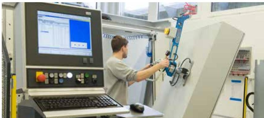
Die Programmierung erfolgt wahlweise auf der Basis einer einfachen und bauteilorientierten Werkstattprogrammierung oder mittels importierten CAD-Daten, z. B. aus EPLAN Pro Panel.
