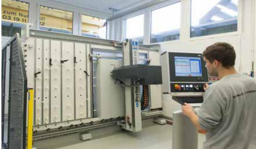
Vollautomatische und exakte Bearbeitung eines Schaltschranks mittels einer Kiesling Maschine 1007 HS.
