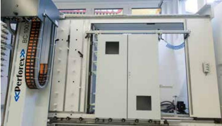
Bearbeitete Schaltschranktüren mittels eines Kiesling Bearbeitungszentrums. Es lassen sich alle im Steuerungsbaub üblichen Materialien wie Stahl, Edelstahl, Aluminium, Kupfer und auch Kunststoff bearbeiten.
